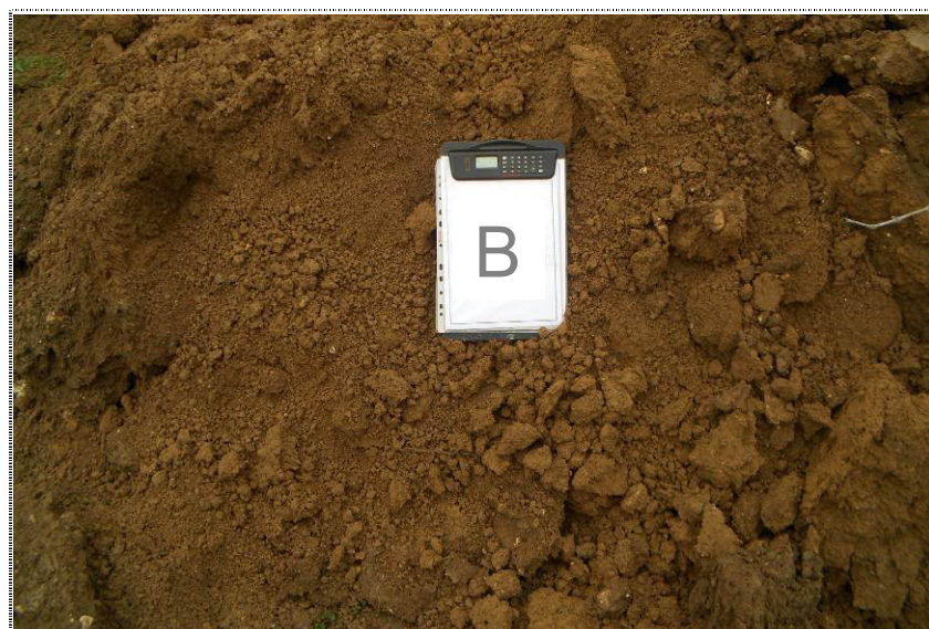
Fig. 4. Particolare del deposito limoso e argilloso in giacitura naturale che costituisce il primo sottosuolo dell'area di studio; la foto si riferisce al materiale riscontrato nello scavo esplorativo "B" (Febbraio 2014).
